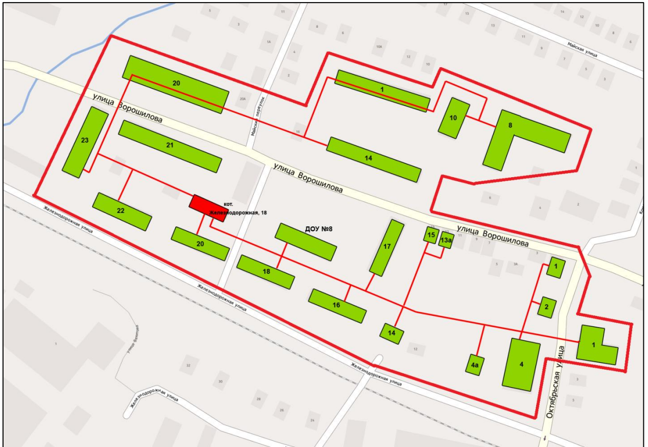
рис. 9 - Зона действия котельной по ул. Железнодорожная, 18
